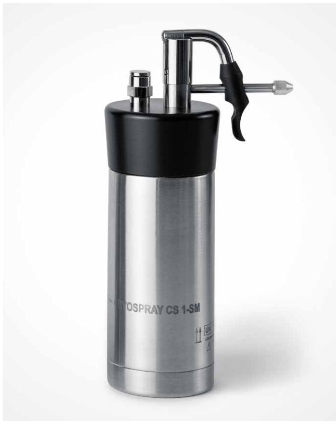
Криоаппарат представляет собой криососуд из нержавеющей стали с вакуумной изоляцией, что позволяет поддерживать внешний корпус аппарата теплым при работе с жидким азотом (-196°C). На пластиковой крышке аппарата расположены два клапана: клапан подачи жидкого азота на обрабатываемую область посредством струи и клапан сброса давления.
